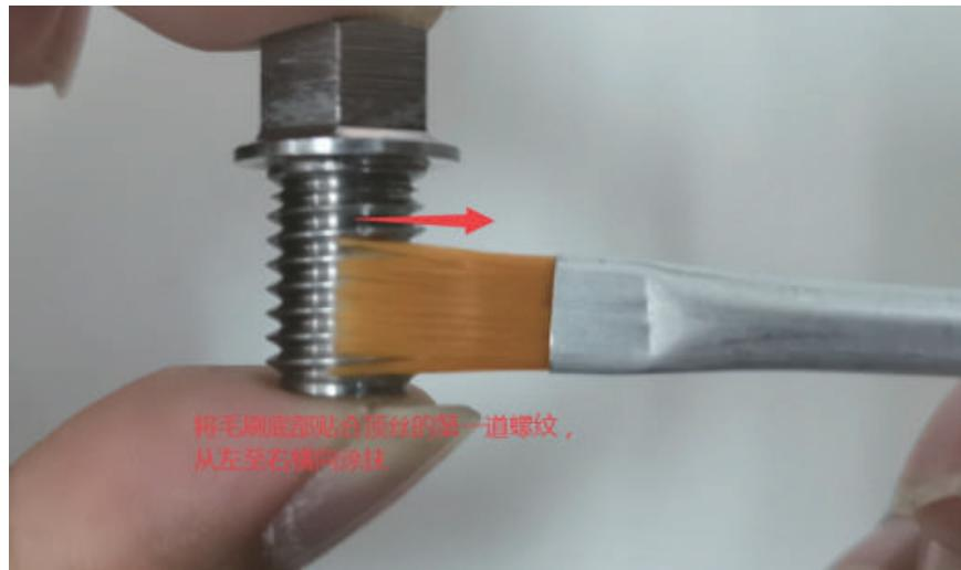
2.3、将顶丝旋进卡钳中，使润滑脂能充分填充螺纹连接处。
