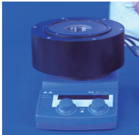
**注意：**切勿将电加热炉的插头，直接插到 220V 电源上！这将导致加热炉迅速升温而烧毁，甚至引发火灾等严重事故。另外，请理顺各线路，任何电气线路不得直接与加热炉或釜体釜盖直接接触，防止线路绝缘层受高温熔化导致短路等事故。
